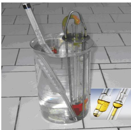
**Fig. 5.** Aparat Ubbelohde pentru determinarea vâscozității
